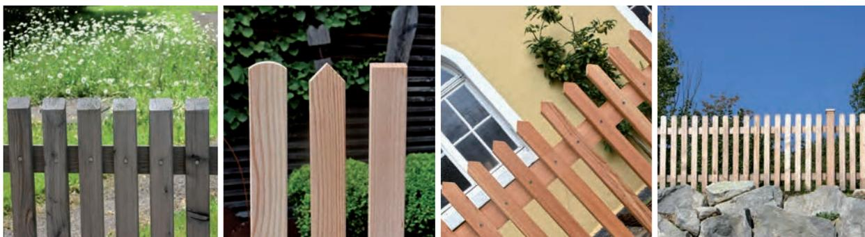
Unsere Zaunelemente bestehen aus unbehandeltem, heimischem Lärchenholz. Latten und Querriegel sind mit Edelstahlschrauben verbunden. Die stabilen, ca. 2,5 cm starken Latten, sind im Abstand von 5-5,5 cm auf den trapezförmigen Querriegeln von vorne sichtbar verschraubt. Sie sind vierseitig gehobelt und gefast. Die horizontalen Trapezriegel sind ca. 3 cm stark und 9 / 7 cm breit und ebenfalls vierseitig gehobelt bzw. gefräst.
