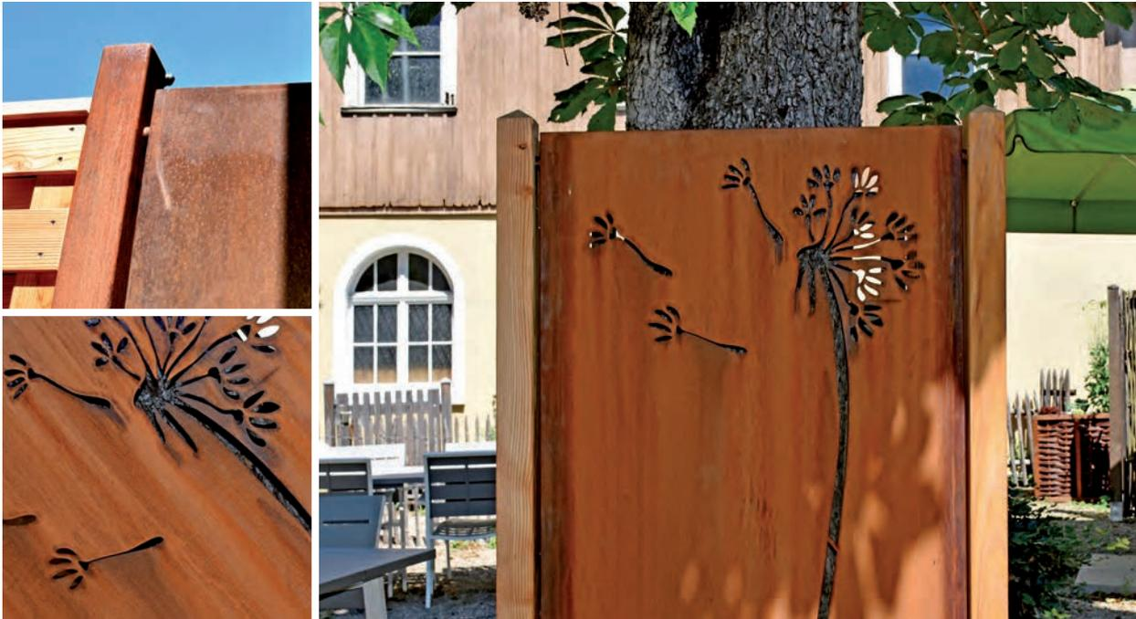
Die hochwertigen, in Deutschland produzierten Sichtschutzelemente bestehen aus vierseitig gekantetem Cortenstahlblech. Dank einer C-förmigen Kantung erhalten die Blechtafeln aus Cortenstahl eine sehr hohe Stabilität.
